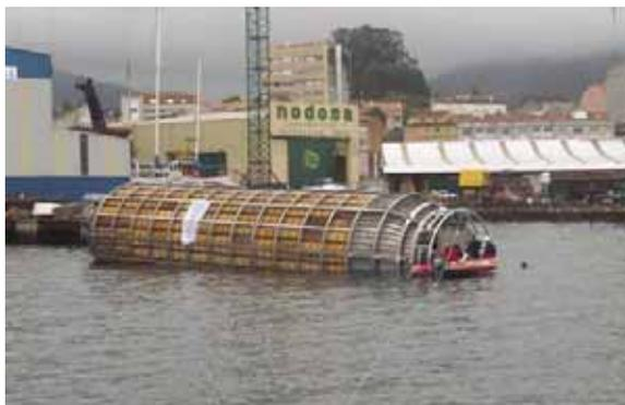
Navette en aluminium utilisée pour évacuer les restes de la cargaison de fioul\* des épaves du *Prestige*
