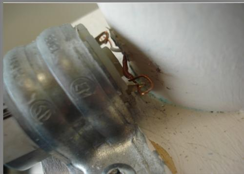
Joindre les fils électriques de l'ampoule DEL aux bornes de connexion du moteur électrique **en respectant la polarité**.
