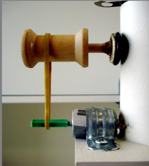
À l'aide d'un élastique (courroie), aligner la poulie du moteur électrique sur la poulie de l'éolienne en s'assurant que la tension est aussi faible que possible.
