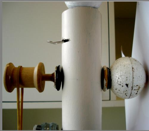
Coller à l'extrémité de l'axe du vire-vent une grosse bobine de fil à coudre (poulie).
