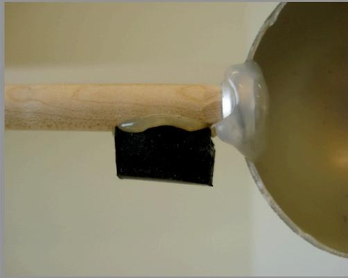
Coller à l'autre extrémité adjacente du bras un morceau de caoutchouc de même poids que l'aimant de façon à constituer un balancier.
