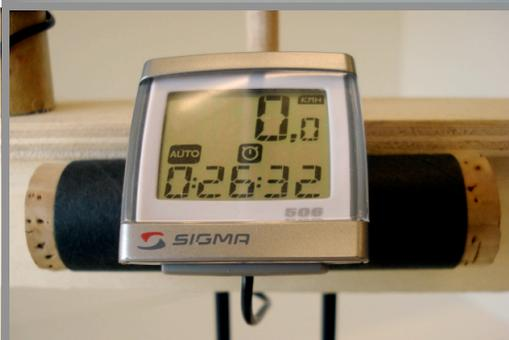
Coller le cylindre de carton rigide au milieu du support de bois léger puis fixer le cyclomètre par dessus.
