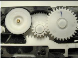
La grande roue de droite s'appuie sur le support du disque qui est denté d'un côté, une crémaillère. Lorsque la roue dentée tourne, le support du disque avance ou recule. Tous ces engrenages qui réduisent la vitesse de rotation du système ont donc deux buts. 1. Faire avancer ou reculer le support du disque à une vitesse qui nous semble convenable. 2. Faire monter ou descendre le support du laser.
