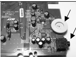
Ici, on voit la plaque électronique qui contrôle le lecteur. Le rond pâle à droite sert à ajuster l'intensité du son, le volume. La pièce noire, juste en dessous, sert à brancher les écouteurs. Une multitude d'autres pièces assurent des fonctions électroniques.
