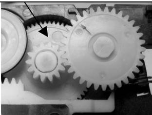
Sur la grande roue dentée se trouve une autre petite roue dentée. Cette dernière a deux fonctions. 1. Positionner le support du laser en faisant bouger la crémaillère (en bas à gauche de l'image). 2. Faire tourner l'autre grande roue dentée, à droite. Tous ces couplages, grandes et petites roues, permettent ici de ralentir la vitesse de rotation.
