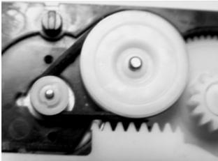
Vu de l'autre sens, la tige du moteur est au centre de la petite roue. Une courroie fait le lien entre la petite et la grande roue. Cette combinaison permet de ralentir la vitesse de rotation du système. Lorsque la petite roue tourne vite, la grande tourne, mais moins vite; puisqu'elle est plus grande. En dessous de la grande roue (non visible ici), il y a une petite roue dentée qui fait tourner une autre grande roue dentée (à droite).
