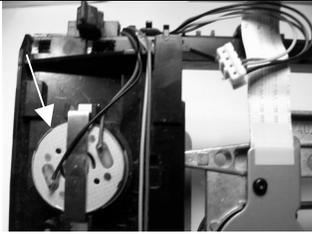
Le moteur du support du disque se trouve dans le coin gauche, au bas de l'image : c'est le petit rond gris. On peut voir les fils qui alimentent le moteur en électricité. Lorsque l'on pousse sur le bouton qui fait ouvrir ou fermer le CD ou DVD, on permet à de l'électricité de mettre en marche ce moteur. Ainsi, le support entre ou sort du boîtier.
