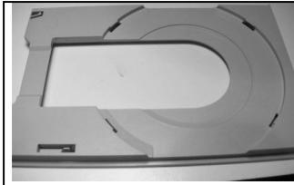
Voici ce sur quoi on pose le disque. Ce support doit pouvoir sortir et entrer dans le lecteur de façon à nous permettre de mettre ou d'enlever un disque. Pour permettre un tel mouvement, il faut, encore une fois, tout un système d'engrenage et... un moteur.
